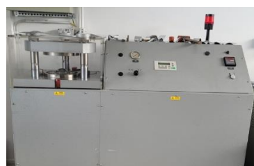
Echipament pentru testul Bulge și încercarea Nakazima
